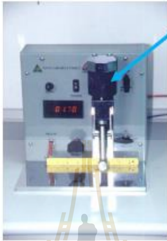
รูปที่ 3.10 เครื่องวัดค่าความพรุน (Porosimeter)
