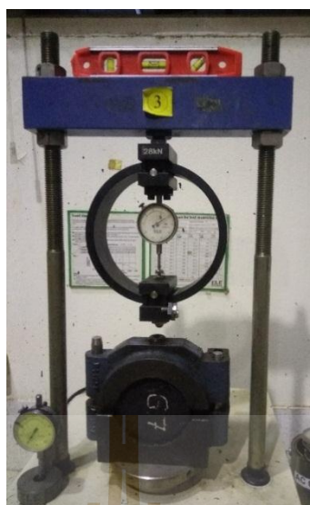
รูปที่ 3.15 การทดสอบค่าเสถียรภาพและการไหลด้วยเครื่องทดสอบ Marshall
