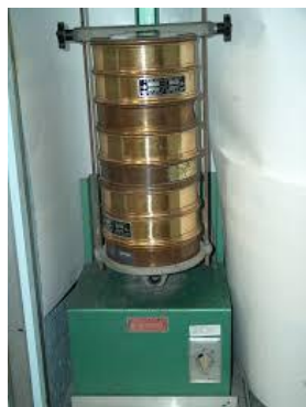
รูปที่ 2.15 อุปกรณ์ที่ใช้ในการทดสอบขนาดคละของมวลรวม ที่มา: M&L Testing Equipment (1995)
