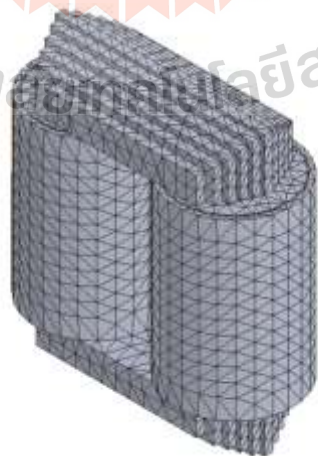
รูปที่ 5.3 ลักษณะการสร้างกริดรูปทรงสี่หน้าของหม้อแปลงไฟฟ้าสำหรับการเชื่อมต่อ แบบวี และแบบสกอตต์
