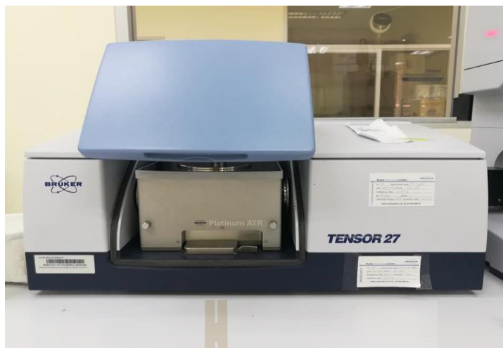
รูปที่ 3.11 เครื่อง fourier transform infrared spectroscopy (FTIR รุ่น Tensor 27)
