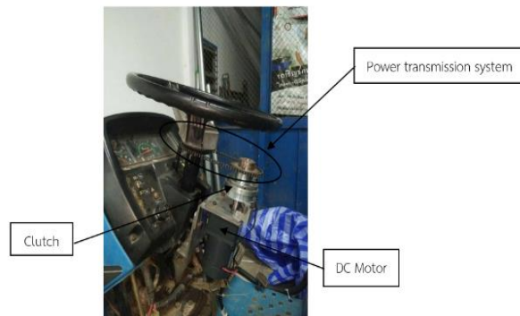
รูปที่ 4.3 ชุดบังคับเลี้ยวสำหรับรถแทรกเตอร์ขนาดเล็ก
