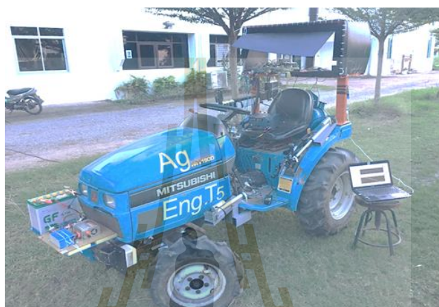
รูปที่ 4.13 การทดสอบสมรรถนะของชุดบังคับกล้วยบนพื้นหญ้า
