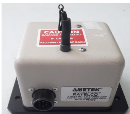
รูปที่ 4.5 ทรานสดีวเซอร์วัดตำแหน่ง ยี่ห้อ AMETEK รุ่น PT-420-60
