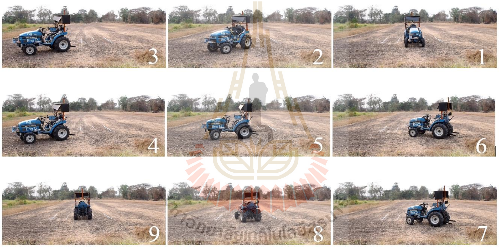
รูปที่ 4.65 การเคลื่อนที่ของรถแทรกเตอร์เกษตรบนเส้นทางกลับหัวแปลงเข้าร่องถัดไป(D=0m) กรณีรถแทรกเตอร์เกษตรกลับหัวแปลงเดี่ยวไปทางขวา
