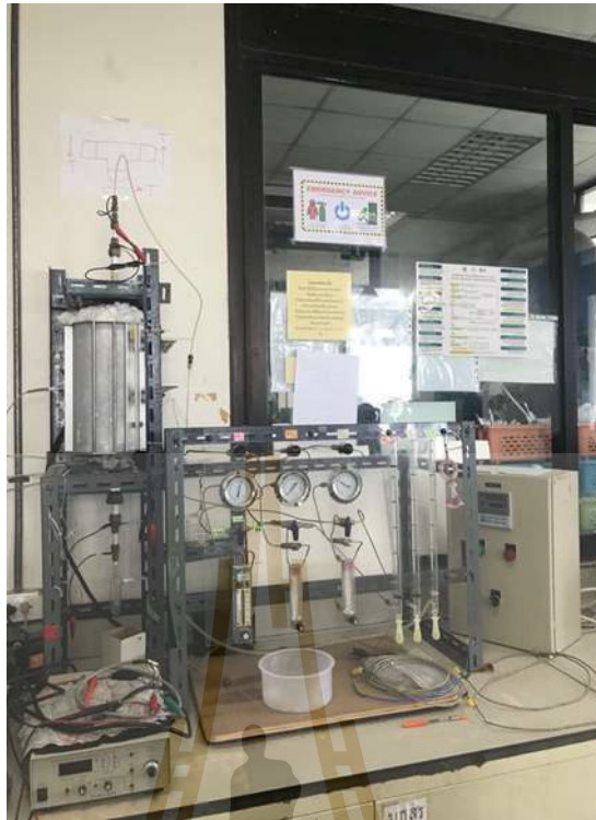
รูปที่ 3.9 ชุดเตาเผาภายใต้แก๊สเชื้อเพลิงและออกซิเจน สำหรับทดสอบสภาวะการทำงานของเซลล์เชื้อเพลิงภายใต้สภาวะเสมือนจริง
