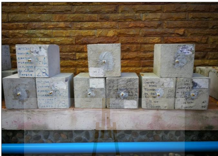
รูปที่ ข.3 เทปูน Non-Shrink ปัดรูใส่สายเอ็นเป็น ตัวกำหนดขนาดรอยร้าว
