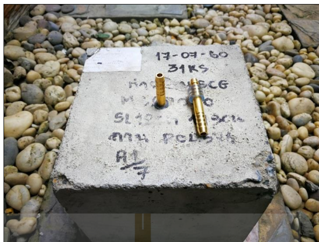
รูปที่ 3.9 การติดตั้งหัวฉีดซีเมนต์เพสต์
