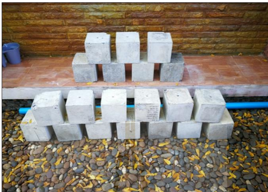
รูปที่ ข.1 เจาะรูแท่งคอนกรีตตัวอย่าง
