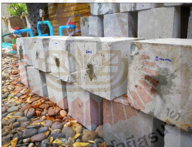
รูปที่ 3.6 จำลองขนาดรอยร้าวในแท่งคอนกรีต
