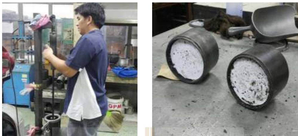
รูปที่ 3.4 การบดทับก้อนตัวอย่างโดยวิธี Marshall ในห้องทดลอง
