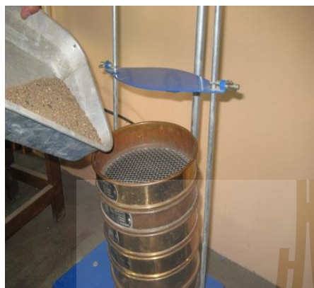
รูปที่ 3.3 การวิเคราะห์หาสัดส่วนและค่าความถี่จำเพาะของมวลรวมละเอียด
