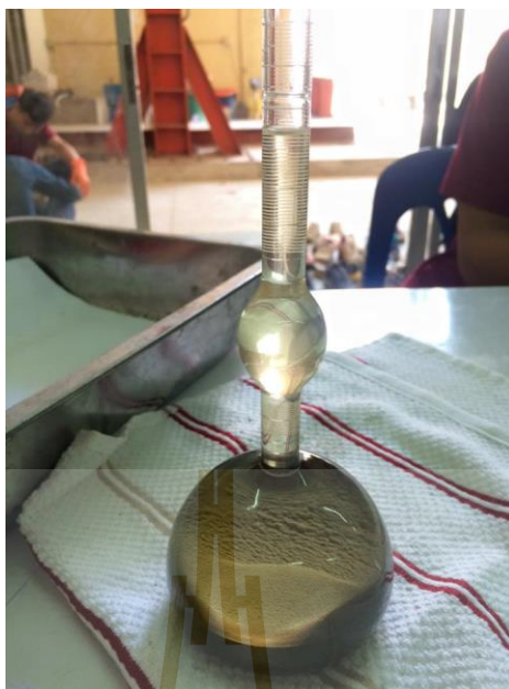
รูปที่ 4.1 ขั้นตอนการคำนวณค่าความถ่วงจำเพาะของปูนซีเมนต์
