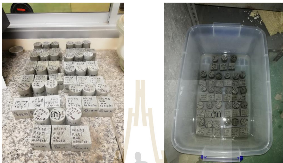
รูปที่ 4.2 (ก) ตัวอย่างก่อนทำการบ่มชื้น (ข) นำตัวอย่างบ่มชื้น
