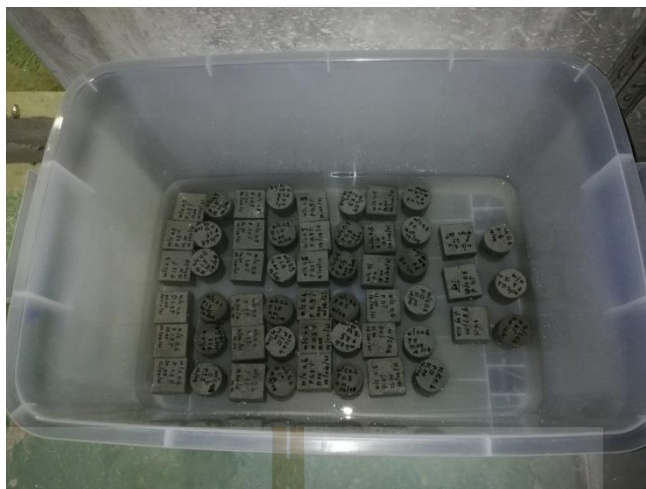
รูปที่ ข. 5 บ่มตัวอย่างซีเมนต์มอร์ตาร์ผสมน้ำยางพารา
