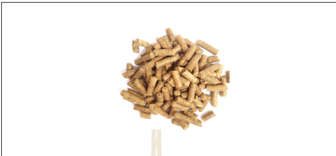
รูปที่ 4.5 ลักษณะของชีวมวลฟางข้าวอัดเม็ดก่อนผ่านกระบวนการทอริแฟลคชัน
