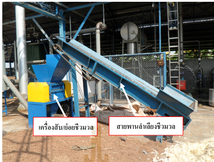
รูปที่ 3.4 เครื่องสับ/ย่อยชีวมวล (Hammer Mill)
