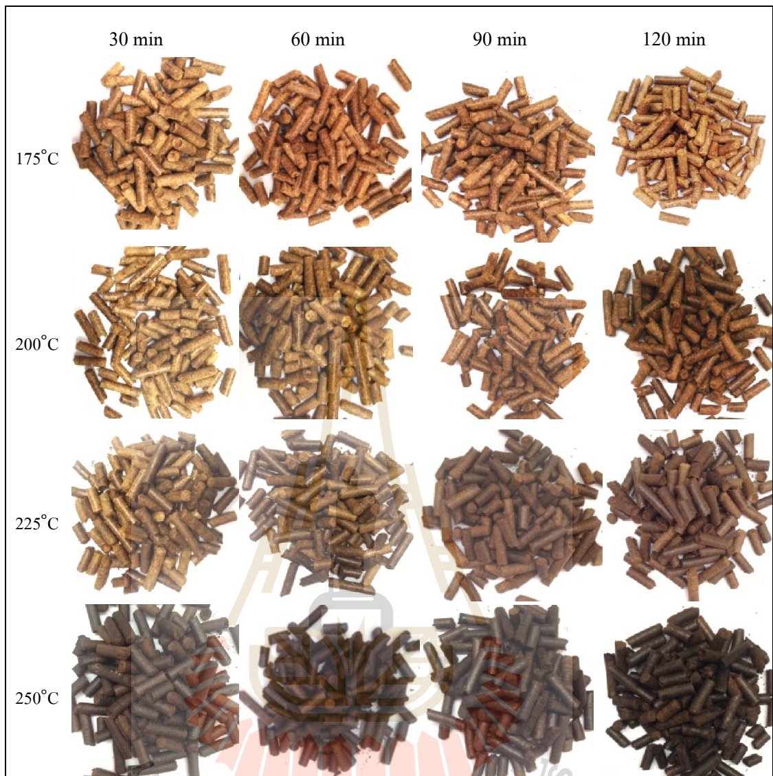
รูปที่ 4.6 ลักษณะของชีวมวลฟางข้าวอัดเม็ดหลังจากกระบวนการทอริแฟคชัน ระดับห้องปฏิบัติการที่อุณหภูมิและเวลาต่าง ๆ
