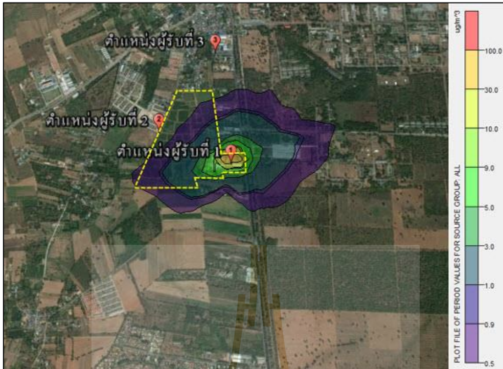
รูปที่ 4-11 เส้นชั้นระดับความเข้มข้นเฉลี่ย 1 ปีของฝุ่นละอองบริเวณบริษัทอุตสาหกรรมแปงโคราช
