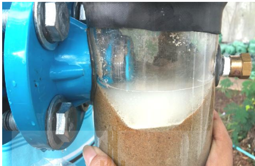
รูปที่ 4.25 การดูดซับจากสารประกอบแคลเซียมคาร์บอเนต(ตะกอนสีขาว)ในน้ำเดิม
