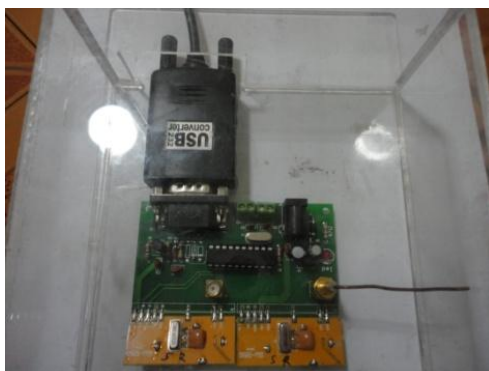
รูปที่ 4.5 RFID Dual Receiver ก่อนการใช้งาน
