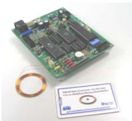
รูปที่ 2.6 บอร์ดเครื่องอ่าน RFID ย่านความถี่ต่ำ
