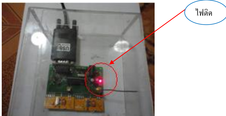
รูปที่ 4.6 RFID Dual Receiver เมื่อมีการเซตค่าพร้อมใช้งาน
