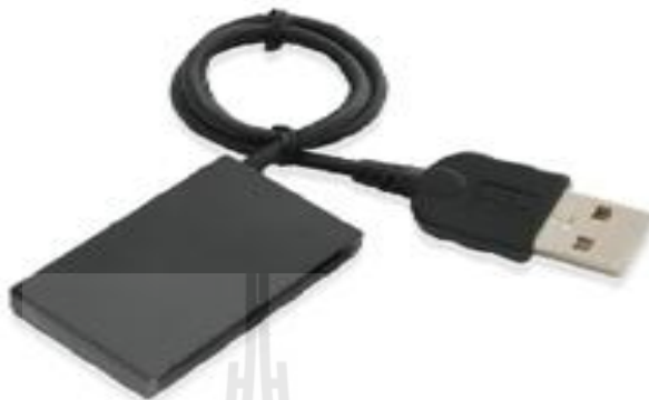
รูปที่ 3.5 Adapter Express Card to USB Cable
