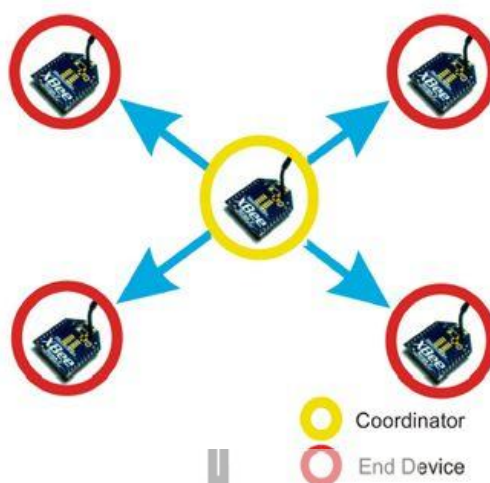
รูปที่ 4.3 โครงข่ายไร้สายของ Xbee ในโครงการ
