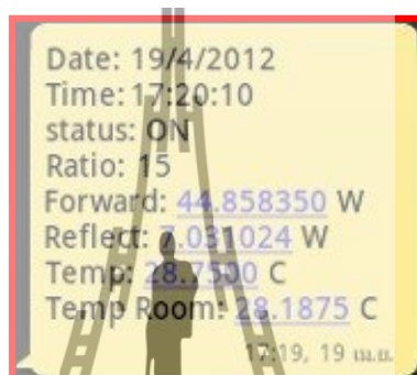
รูปที่ 4.6 ข้อความ SMS แสดงข้อมูลของเครื่องส่งวิทยุกระจายเสียง
