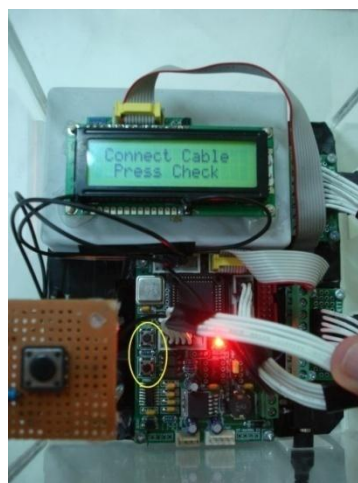
รูปที่ 4.12 แสดงการทำ Reset บอร์ด Microcontroller
