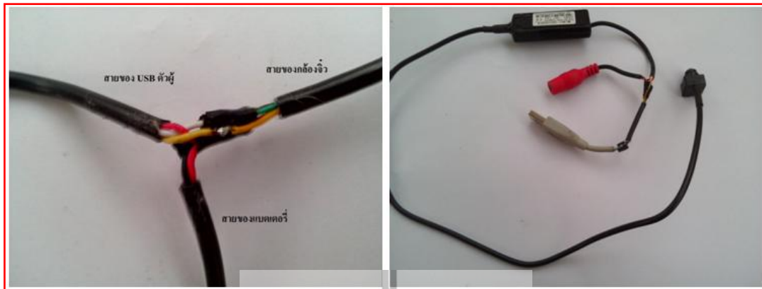
รูปที่ 3.29 การต่อสายแหล่งจ่ายกระแสไฟฟ้ากับ USB (ตัวเมีย)
