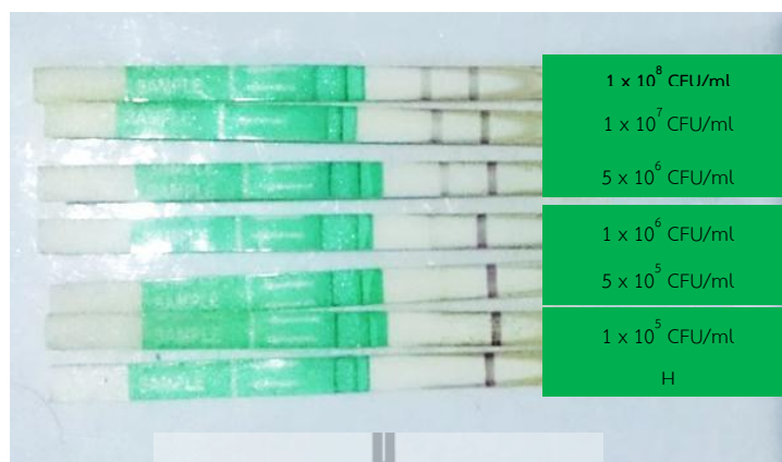
รูปที่ 6. ชุดตรวจสอบโรคผลเน่าแบคทีเรียที่เกิดจากเชื้อ Acidovorax avenae subsp. Citrulli ( Aac ) [LFA ได้รับความอนุเคราะห์จากนักวิจัยของไบโอเทค]
