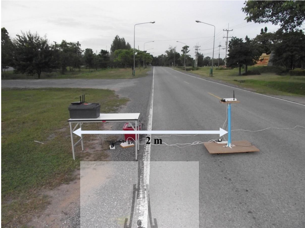
รูปที่ 4.13 จำลองการสร้างสัญญาณรบกวนที่เข้ามารบกวนการส่ง-รับสัญญาณของกล่องสัญญาณ OBU ที่มีระยะห่างกับกล่องรับสัญญาณ (OBU2) เท่ากับ 2 เมตร ในกรณี Omnidirectional - Omnidirectional
