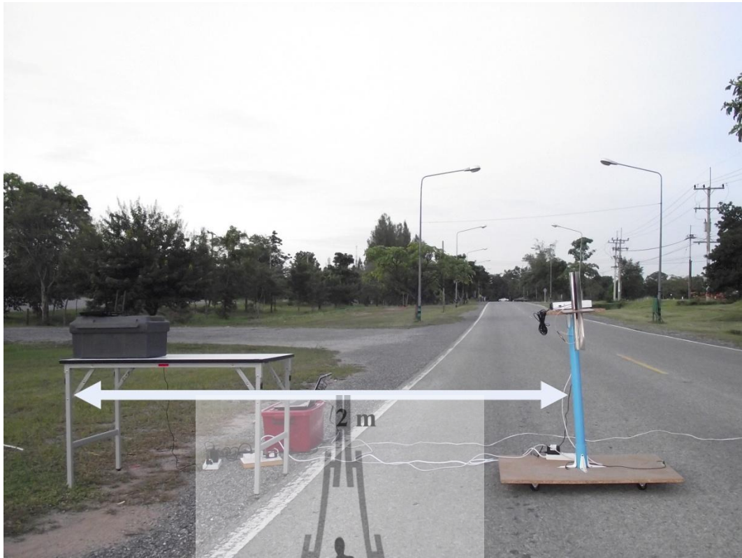
รูปที่ 4.19 จำลองการสร้างสัญญาณรบกวนที่เข้ามารบกวนการส่ง-รับสัญญาณของกล่องสัญญาณ OBU ที่มีระยะห่างกับกล่องรับสัญญาณ (OBU2) เท่ากับ 2 เมตร ในกรณี Directional - Directional
