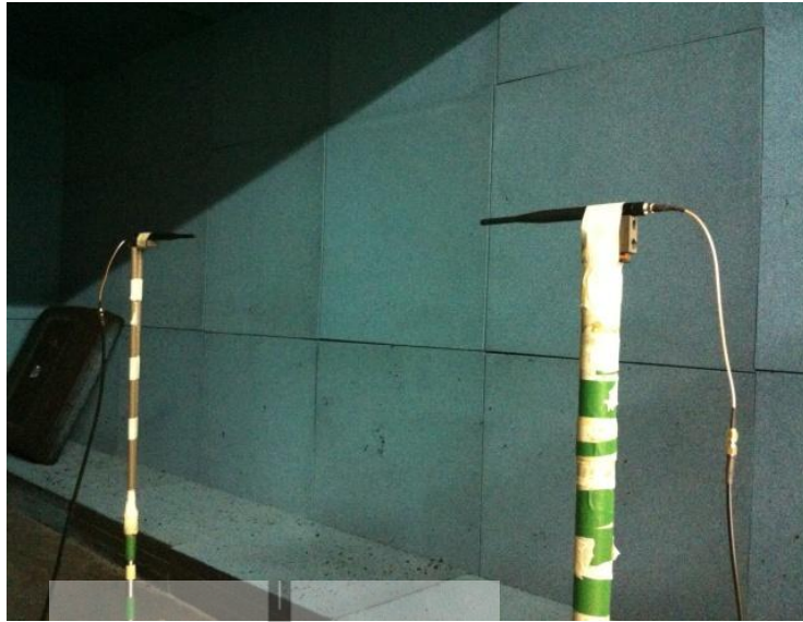
รูปที่ 3.34 การวางตัวของสายอากาศแบบโมโนโพลเพื่อศึกษาวัดแบบรูปการแผ่พลังงาน ในระนาบ E - Plane
