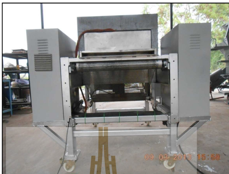
(ก) เตาอบไมโครเวฟแบบสายพานร่วมกับลมร้อนด้านหน้า
