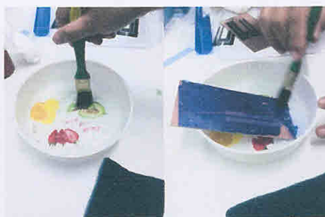
รูปที่ 5.15 ขั้นตอนการลอกแผ่นไคร์ฟิล์มด้วยผงโซเดียมก่อนการนำไปกัดด้วยน้ำยากัด เพื่อให้ได้ลายปรินต์ที่ต้องการ
