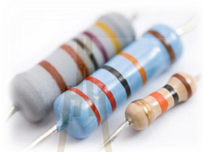
รูปที่ 2.6 แสดงลักษณะของตัวต้านทานแบบค่าคงที่ [8]
