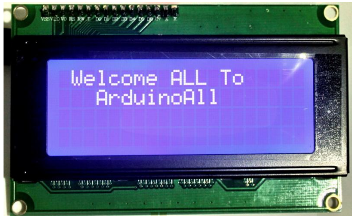
รูปที่ 2.4 จอแสดงผล LCD ขนาด 20 ตัวอักษร 4 บรรทัด ใช้ไฟ 5 โวลต์ ไฟ backlight สีฟ้า [6]
