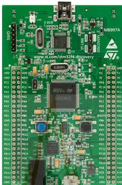
รูปที่ 2.2 แสดงพอร์ตต่างๆของStm32f4Discovery หรือ Waijung board [4]
