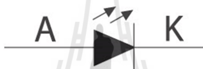
รูปที่ 2.17 สัญลักษณ์ของ LED ในวงจรไฟฟ้า [13]
