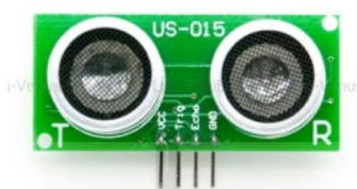
รูปที่ 2.5 เซนเซอร์วัดระยะทางรุ่น US-015 [6]
