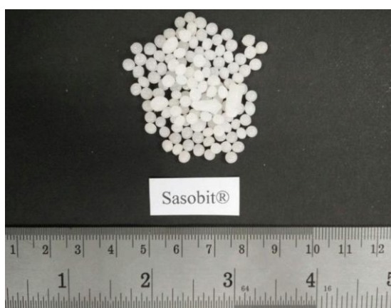
รูปที่ 2.5 ลักษณะของสารผสมเพิ่มชนิดอินทรีย์ (Sasobit ®)
