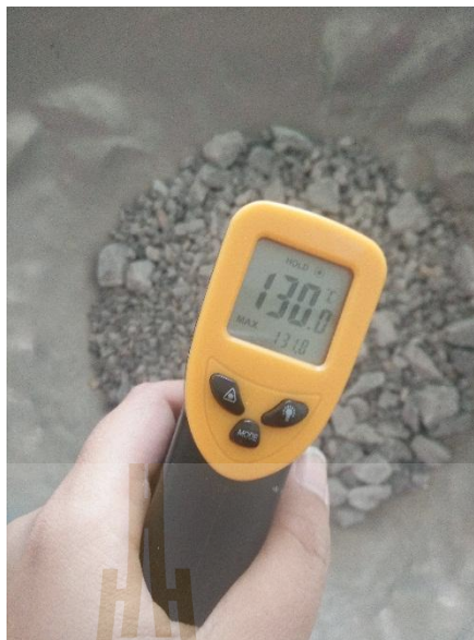
รูปที่ 3.10 ตรวจสอบอุณหภูมิด้วยInfrared Thermometer Gun
