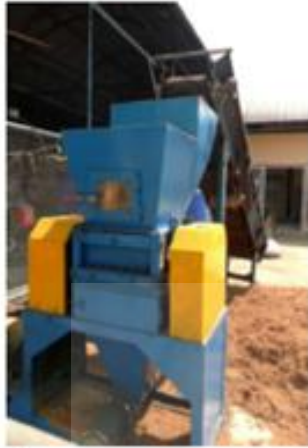
รูปที่ 3 เครื่องสับ/บดวัสดุชีวมวล (Biomass chipper)
