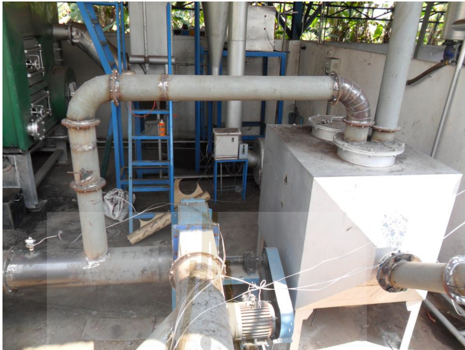
รูปที่ 3.8 ถังผสม ไอเสียจากเครื่องกำเนิดไอน้ำ
