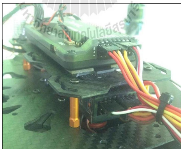
รูปที่ ก.7 แสดงการต่อสัญญาณฝั่ง Input กับชุดรับสัญญาณ
