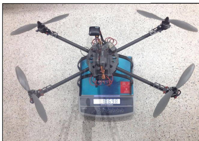
รูปที่ 4.9 แสดงน้ำหนักของอากาศยานสี่ใบพัดต้นแบบลำที่ 2
