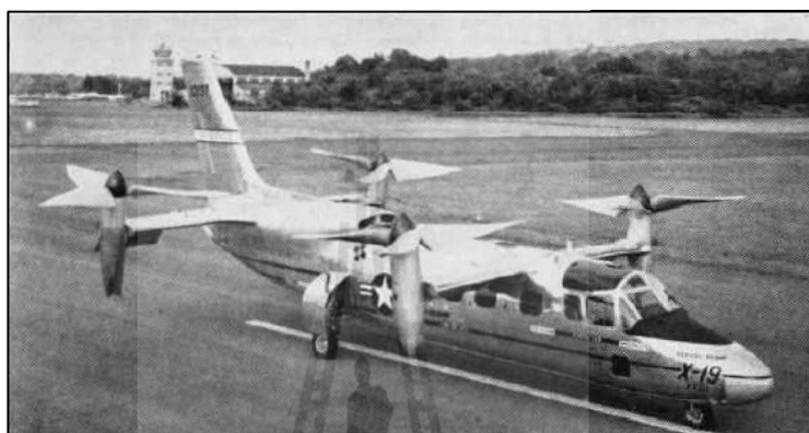
รูปที่ 2.5 แสดงอากาศยานแบบสี่ใบพัดแบบ Curtiss-Wright X-19
