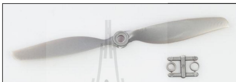
รูปที่ 3.2 แสดงใบพัด ชนิด APC ขนาด 11 x 4.7
