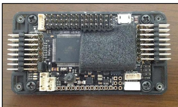
รูปที่ 4.7 แสดงการนำฟองน้ำมาปิดบารอมิเตอร์
