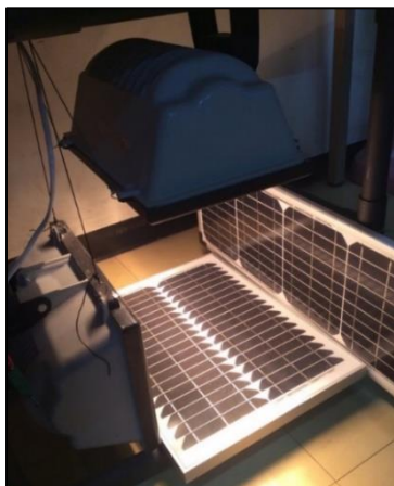
รูปที่ 4.44 แสงอาทิตย์เทียมในห้องปฏิบัติการ
