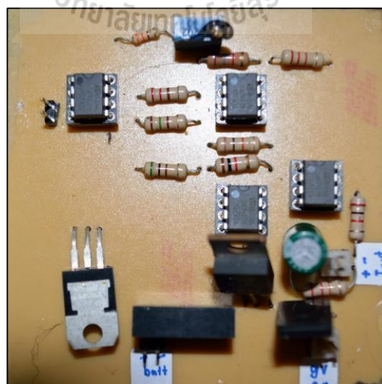
รูปที่ 5.16 วงจรปรับแต่งสัญญาณที่ใช้งานจริง
