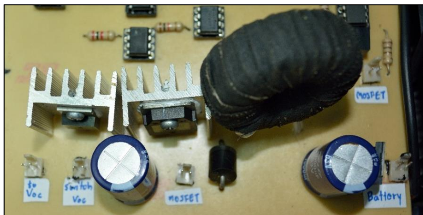
รูปที่ 4.42 วงจรแปลงผันแบบบัคค์ที่ใช้งานจริง
