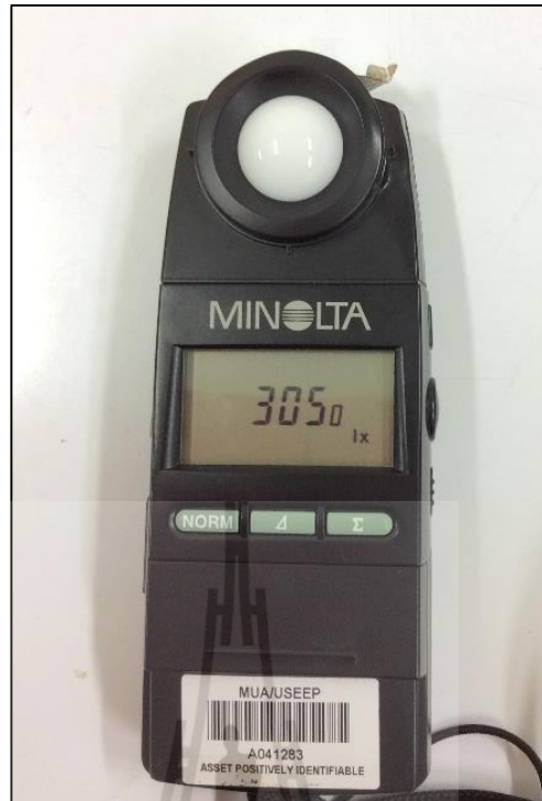
รูปที่ 4.46 เครื่องมือวัดความเข้มแสง หรือ lux meter
