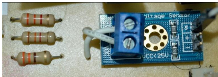
รูปที่ 5.10 วงจรตรวจจับแรงดันของแผงเซลล์แสงอาทิตย์
