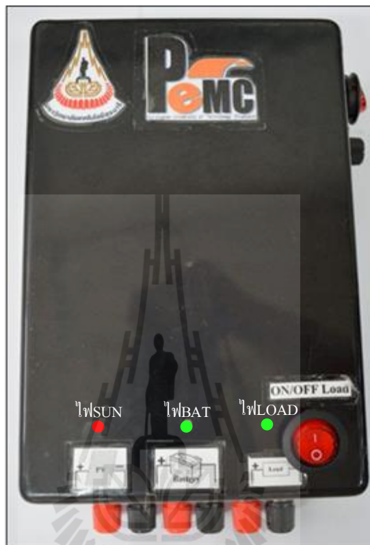
รูปที่ ง.3 กล่องชุดชาร์จเซลล์แสงอาทิตย์ที่มีการตามรอยกำลังงานสูงสุดด้วยวิธี P&O
