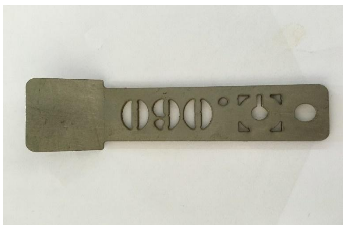
รูปที่ 3.11 แสดงตัวอย่างเกจที่ใช้ในการตั้งระยะความสูงหัวตัดที่ใช้ในการตัดอะลูมิเนียม
