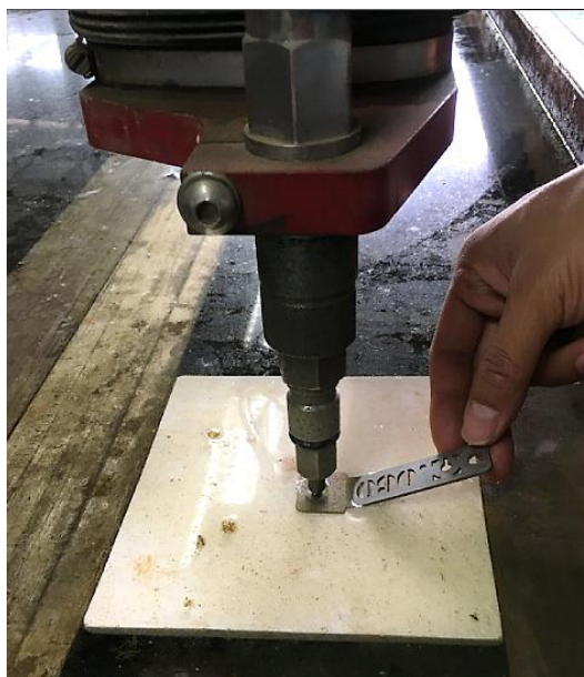
รูปที่ 3.19 แสดงตำแหน่งหัวตัดจะใช้เกจขนาด 30 \times 100 มิลลิเมตรหนา 2 มิลลิเมตร \pm 0.050 มิลลิเมตรตั้งค่าความสูงหัวตัด
