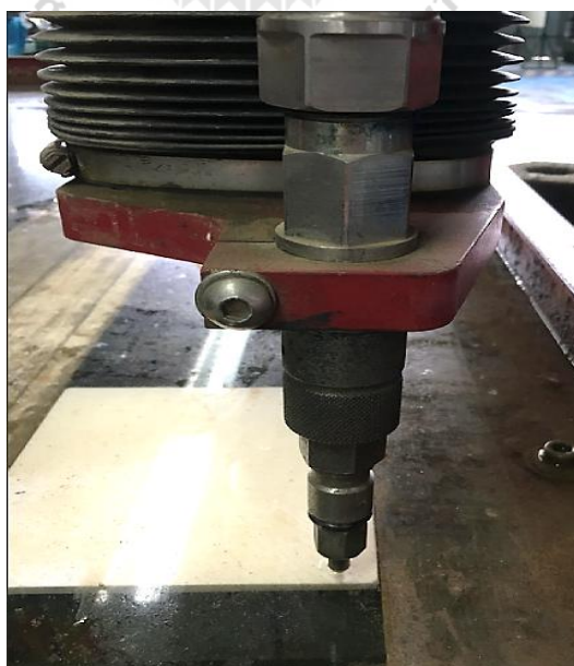
รูปที่ 3.20 แสดงตั้งค่าตำแหน่งเริ่มต้นในการตัด
