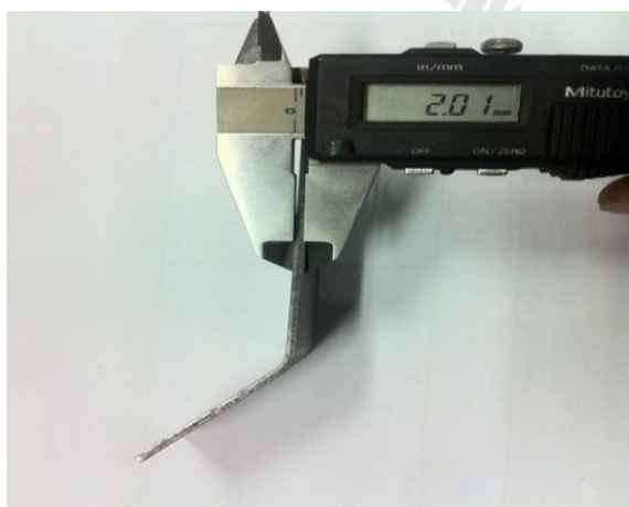
รูปที่ 3.12 แสดงภาพการตรวจสอบค่าความหนาของเกจตั้งความสูงหัวตัด หนา 2 มิลลิเมตร \pm 0.050
