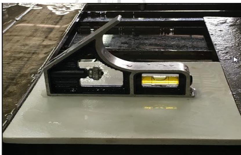
รูปที่ 3.18แสดงการจับยึดหลักแผ่นบนเครื่องตัดวัสดุแรงดันน้ำสูง
