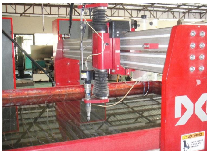
รูปที่ 3.5 แสดงตำแหน่งหัวตัดห่างจากแกน X ประมาณ 800 มิลลิเมตร และห่างจากแกน Y ประมาณ 800 มิลลิเมตร
