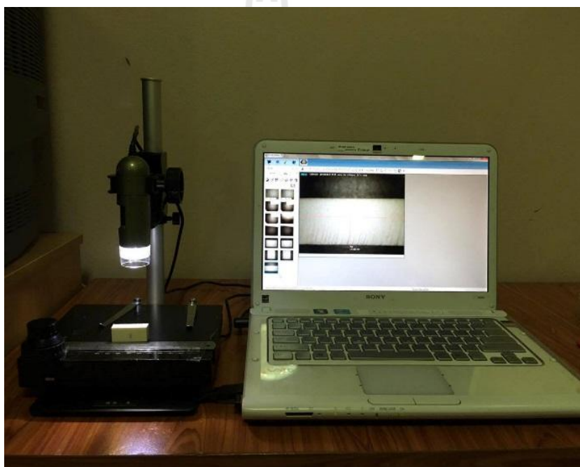
รูปที่ 3.29แสดงตัวอย่างการถ่ายรูปความสูงคลื่นรอยตัด โดยใช้กล้องจุลทรรศน์
