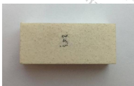
รูปที่ 3.1 แสดงชิ้นงานที่ทำการทดลองตัด ขนาด 15 \times 35 \times N มิลลิเมตร
