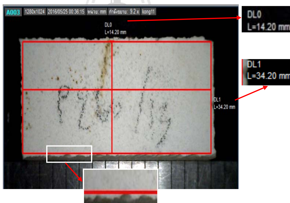
รูปที่ 4.16 แสดงรูปตัวอย่างการวัดรอยแตกร้าวของชั้นงาน
