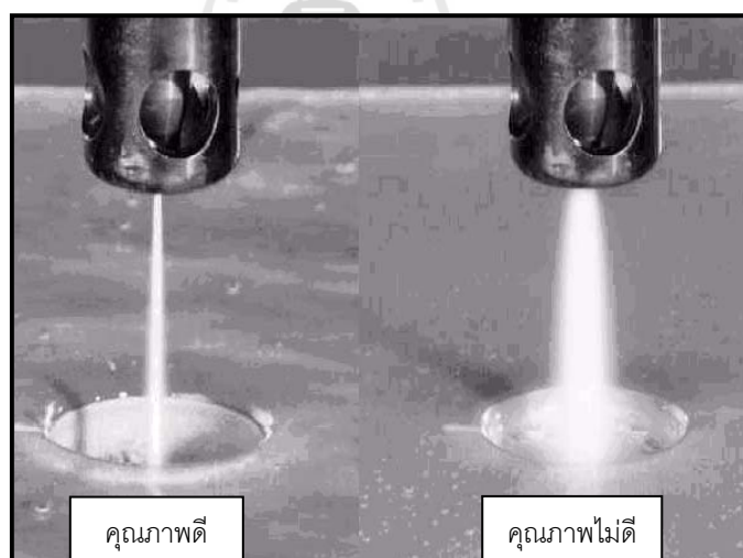
รูปที่ ค.4 แสดงตัวอย่างคุณภาพเจ็ทสตรีมของทั้งดีและไม่ดี
