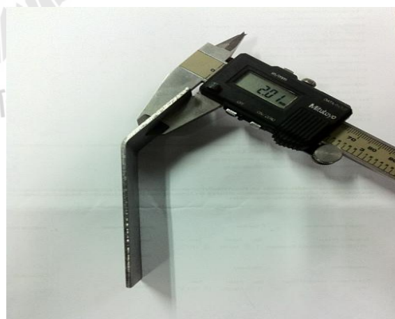
รูปที่ 3.12 แสดงภาพการตรวจสอบค่าความหนาของเกจตั้งความสูงหัวตัด หนา 2 มิลลิเมตร \pm 0.050
