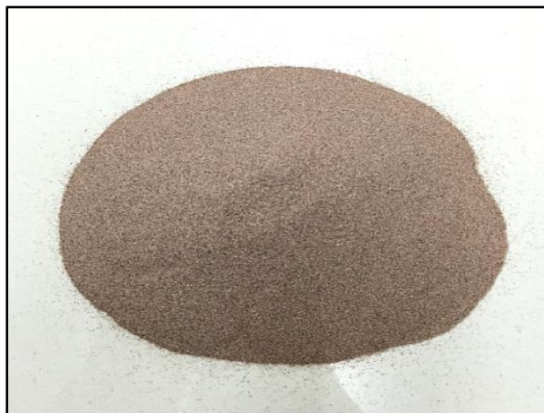
รูปที่ 3.9 แสดงชนิดสารขัดทราย (Garnet)
