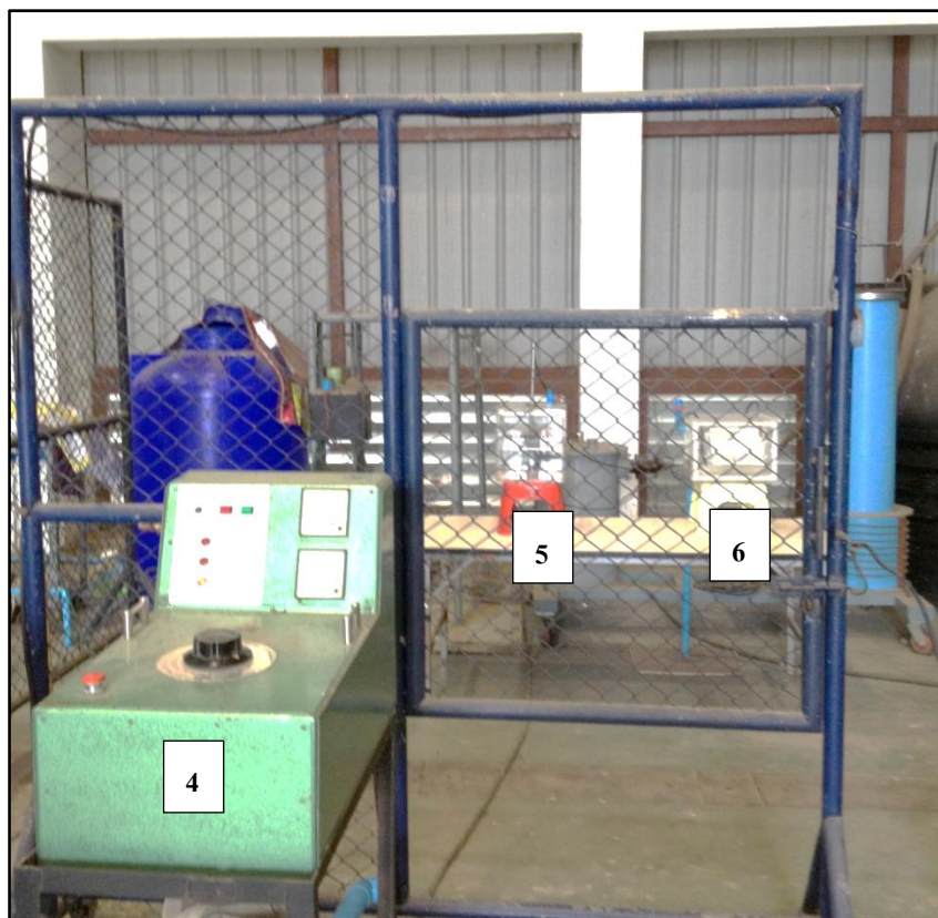
รูปที่ 4.24 ชุดทดสอบการเร่งการเสื่อมอายุของฉนวนยางซิลิโคนกรณีไร้หมอกที่สร้างเสร็จ
