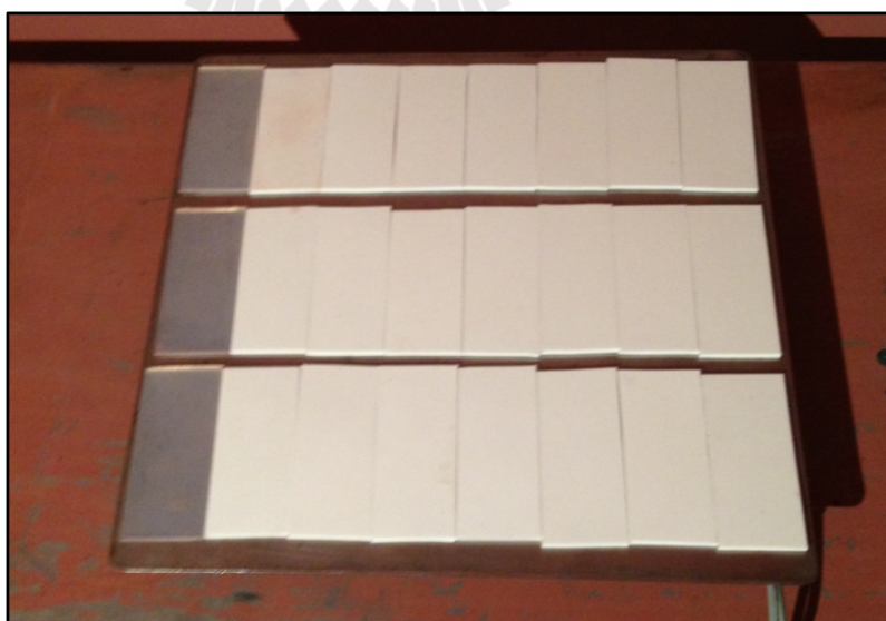
รูปที่ 5.4 ลักษณะการวางแผ่นฉนวนยางซิลิโคนบนอิเล็กโทรดระนาบในกรณีหมอกสะอาดและหมอกไอเกลือ
