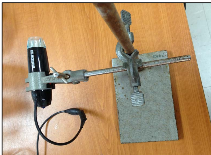
รูปที่ 4.54 ลักษณะกล้องบันทึกภาพและการติดตั้งกล้องบันทึกภาพ
