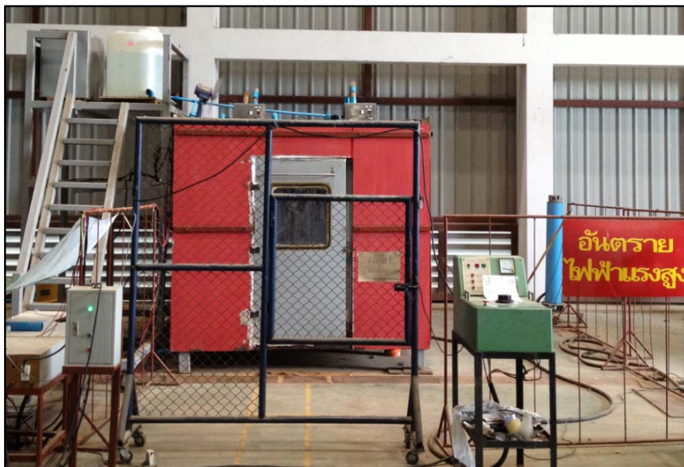
รูปที่ 4.25 ลักษณะห้องทดสอบปิดในการทดสอบการเร่งการเสื่อมอายุของฉนวนขางซิลิโคนกรณีหมอกสะอาดและหมอกไอเกลือ
