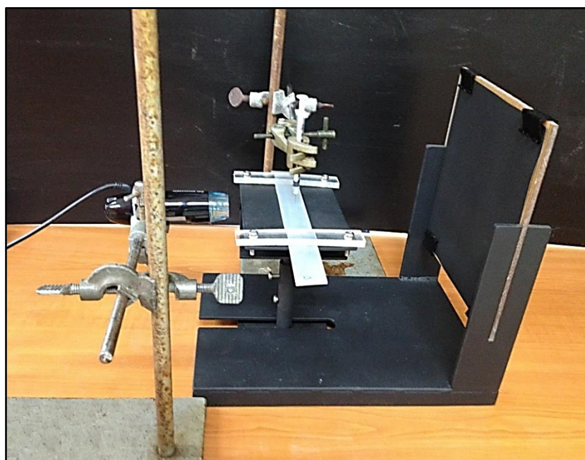
รูปที่ 4.56 ลักษณะการประกอบฐานชุดวัดมุมสัมผัสในแต่ละส่วน
