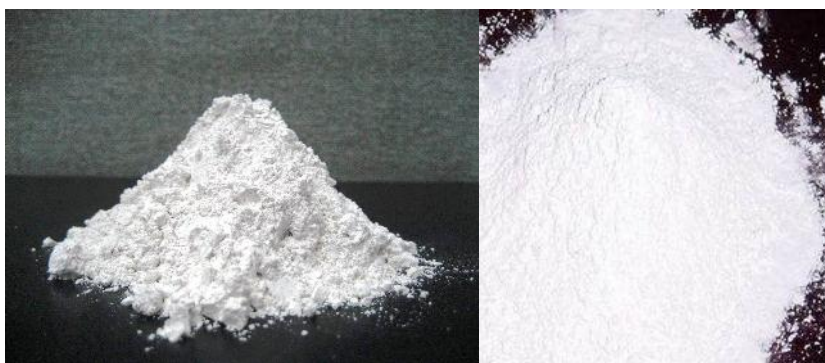
รูปที่ 2.13 ลักษณะของผงปูนขาวไฮดรตที่นำมาใช้ประโยชน์ในงานอุตสาหกรรม (ปณชัย, 2551)
