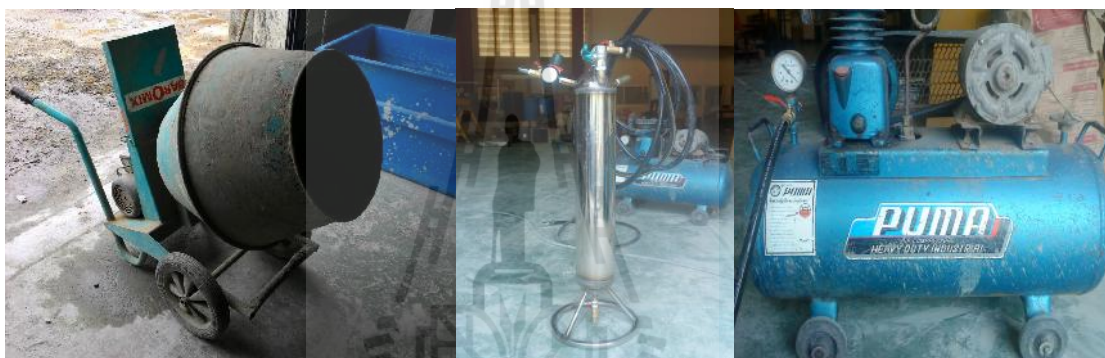
รูปที่ 3.2 เครื่องผสมคอนกรีต เครื่องกำเนิดโฟมเหลว (Foaming generator) และปั๊มลม
