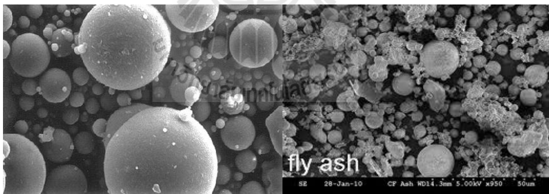
รูปที่ 2.11 ภาพถ่าย Scanning Electron Microscopy (SEM) ของเถ้าลอย (ศักดิ์สิทธิ์, 2551)
