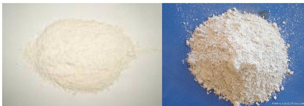
รูปที่ 2.12 ลักษณะของผงปูนขาว (ปูนสุก) ที่นำมาใช้ประโยชน์ในงานอุตสาหกรรม (ปณชัย, 2551)
