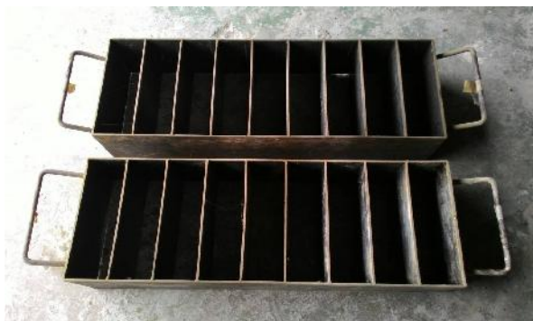
รูปที่ 3.1 แบบหล่อก้อนตัวอย่างขนาดมาตรฐาน 215 x 103 x 65 มม
