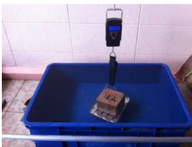
รูปที่ 3.19 การชั่งน้ำหนักศิลาแสงเทียมในน้ำ
