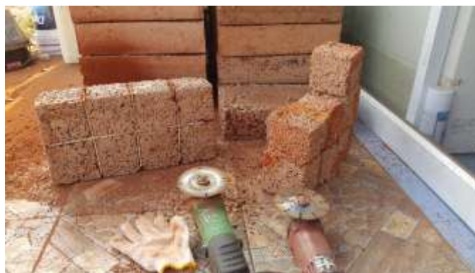
รูปที่ 3.13 ก่อนตัวอย่างศิลาแลงขนาด 0.1x0.1x0.1 ลูกบาศก์เมตร
