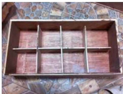
รูปที่ 3.7 แบบหล่อตัวอย่างศิลาแลงขนาด 0.20x0.40x0.10 ลูกบาศก์เมตร
