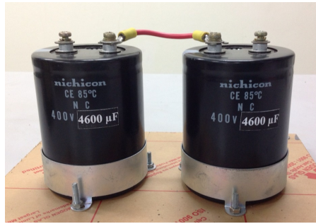
รูปที่ 10.9 ตัวเก็บประจุ C_{dc} ขนาดเท่ากับ 2300 \mu\text{F}
