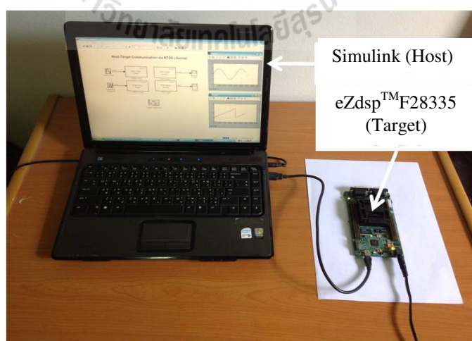
รูปที่ 6.15 การเชื่อมต่อฮาร์ดแวร์ระหว่างคอมพิวเตอร์โปรแกรม Simulink กับบอร์ด eZdsp™ F28335
