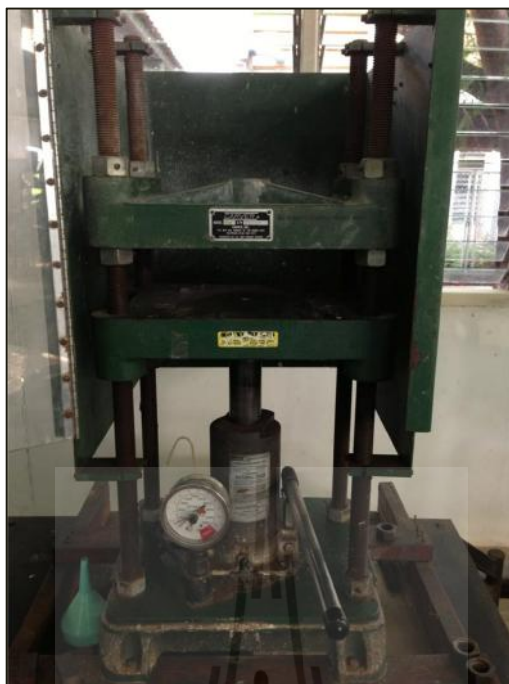
รูปที่ 2.3 เครื่องอัดขึ้นรูปแบบ Dry press ยี่ห้อ CARVER รุ่น 2702-227
