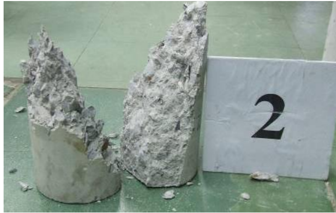
รูปที่ 4.4 ลักษณะการวิบัติของตัวอย่างคอนกรีต
