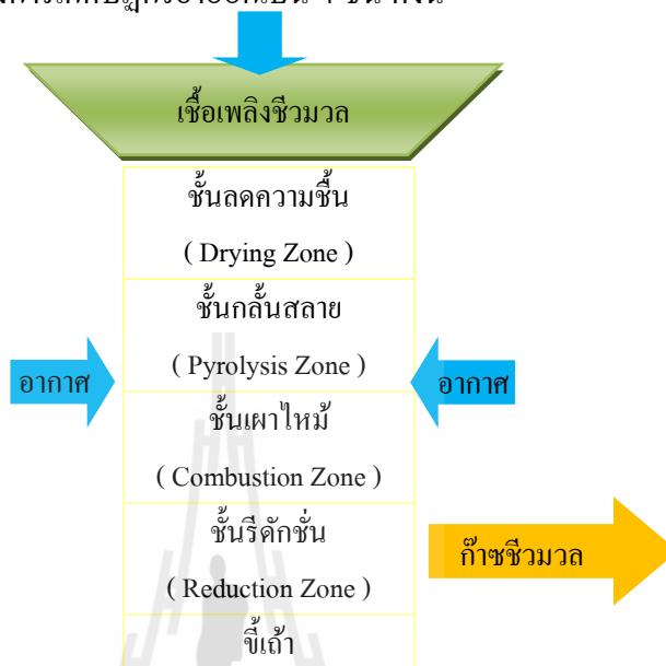
รูปที่ ง.1.1 กระบวนการเกิดก๊าซใน Open Top Downdraft Gasification
