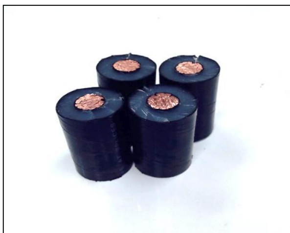
รูปที่ 6.2 ชิ้นส่วนของสายเคเบิลที่ถูกตัดมีความยาว 4 cm
