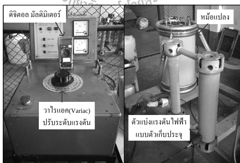
รูปที่ 5.7 ชุดป้อนแรงดันไฟฟ้าแรงสูงสำหรับทดสอบ
