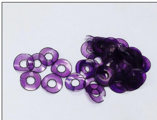
รูปที่ 6.7 ชิ้นส่วนของฉนวน XLPE ที่ทำการเชื่อมสี่ด้วยเมทิลีนบลู
