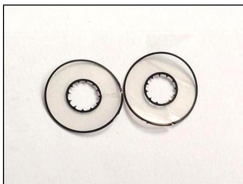
รูปที่ 6.5 ฉนวน XLPE ที่ถูกฉีกด้วยเครื่องไมโครโทรม
