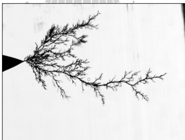
รูปที่ 3.28 ทรีอิงทางไฟฟ้าที่งอกออกมาจากปลายเข็ม
