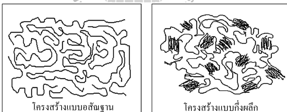
รูปที่ 3.5 ลักษณะโครงสร้างของพอลิเมอร์แบบอสัณฐานและแบบกึ่งผลึก
