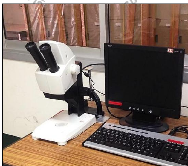
รูปที่ 6.8 กล้องจุลทรรศน์แบบสเตอริโอ LEICA รุ่น EZ4D
