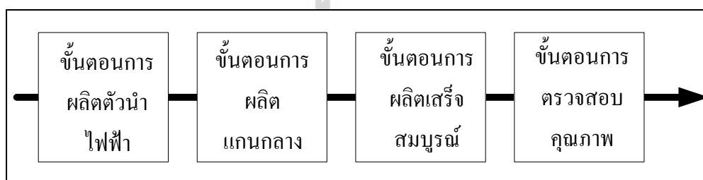
รูปที่ 3.15 ขั้นตอนการผลิตสายเคเบิลแรงสูงฉนวน XLPE
