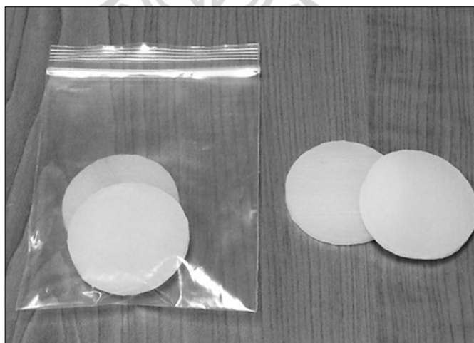
รูปที่ 5.18 ฉนวน XLPE ที่ตัดมาจากสายเคเบิล 115 kV มีขนาดความหนา 4 mm
