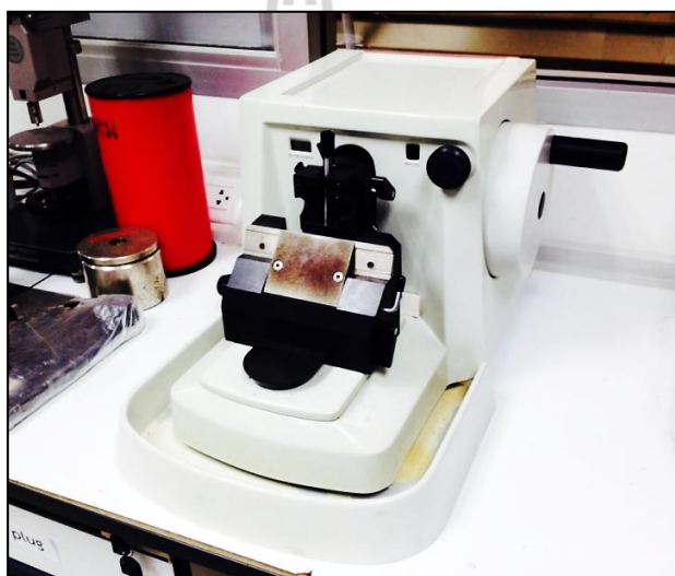
รูปที่ 6.4 เครื่องไมโครโทรมที่ใช้ฉีกฉนวนสายเคเบิล
