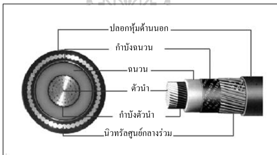
รูปที่ 3.12 สายเคเบิลแรงสูงได้ฉนวน XLPE
