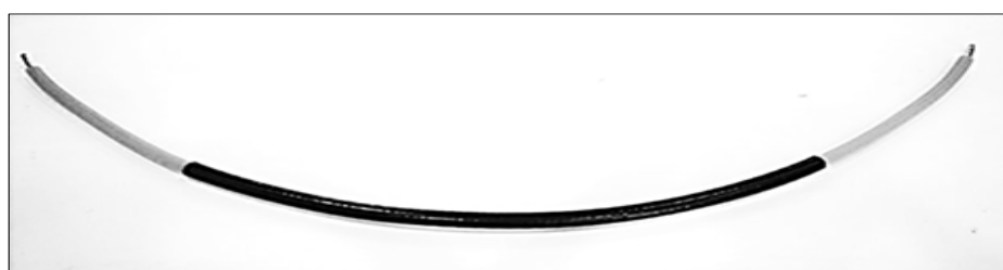
รูปที่ 5.9 สายเคเบิลแรงสูงฉนวน XLPE ที่ใช้ในการทดสอบ
