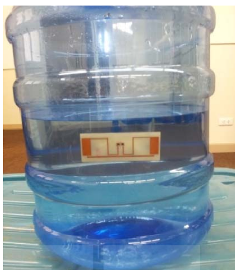
รูปที่ 5.16 สายอากาศไดโพลแท่งบนวัสดุที่บรรจุน้ำ
