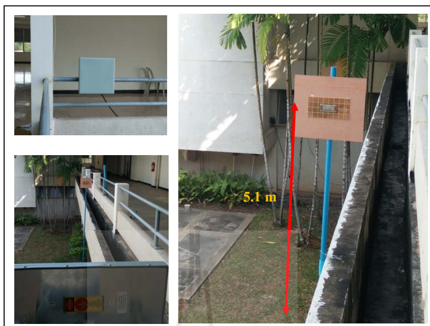
(ข) แท้กร่วมกับช่องว่างแถบความถี่แม่เหล็กไฟฟ้าที่ความสูง 5.1 เมตร
