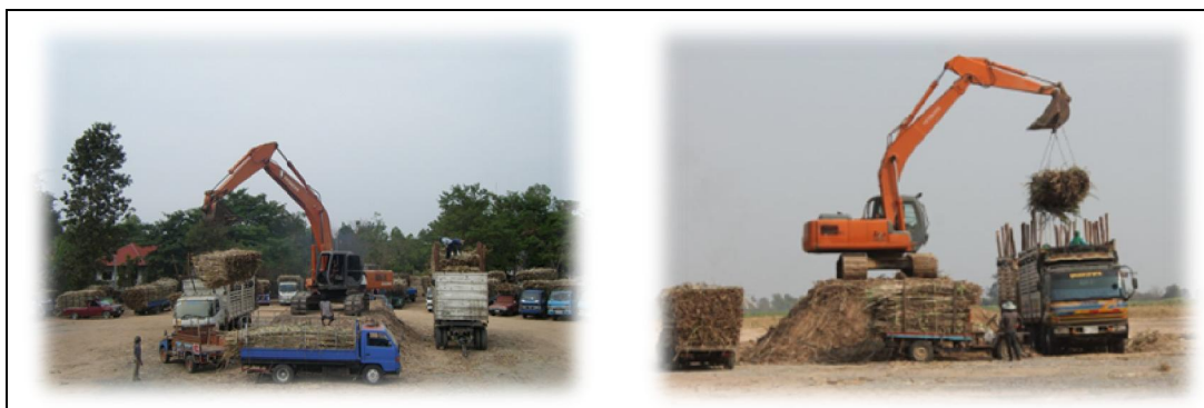
รูปที่ 1.4 สถานีขนถ่ายที่ใช้รถยกย้ายอ้อยจากรถบรรทุกขนาดเล็กใส่รถบรรทุกขนาดใหญ่
