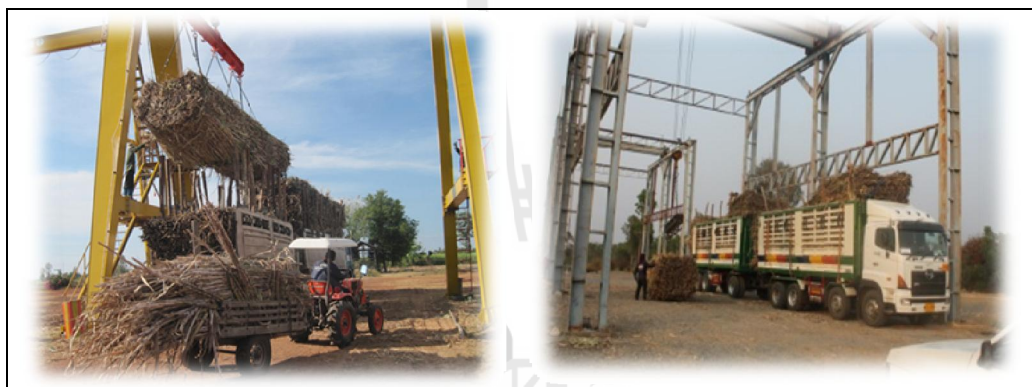
รูปที่ 1.5 สถานีขนถ่ายที่ใช้ปั้นจั่นย้ายอ้อยจากรถบรรทุกขนาดเล็กใส่รถบรรทุกขนาดใหญ่
