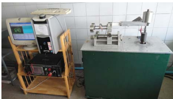
(ค) เครื่องมือทดสอบการสึกหรอแบบพินออนดิสก์ (Pin on Disc)
