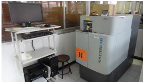
(ก) เครื่องทดสอบส่วนผสมทางเคมีของโลหะ SPECTROLAB
