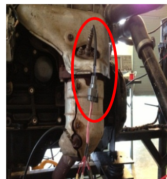
รูปที่ 3.9 ตำแหน่งการวัดของตัวตรวจจับปริมาณออกซิเจน
