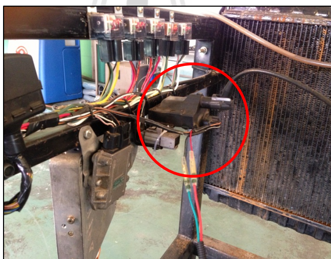
รูปที่ 3.18 ตำแหน่งการวัดสัญญาณคอยล์จุดระเบิด
