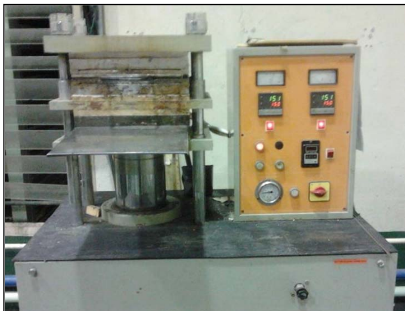
รูปที่ ข.5 เครื่องอัดขึ้นรูปร้อน ขนาด 30 ตัน
