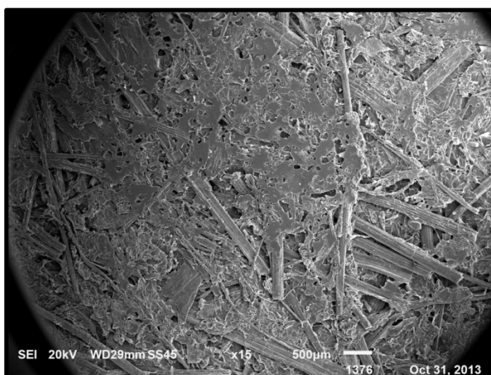
รูปที่ 4.12 ภาพผิวหน้าของชิ้นงานที่มีเส้นใยขนาด 5 มิลลิเมตร ปริมาณเส้นใย 66.67 %
