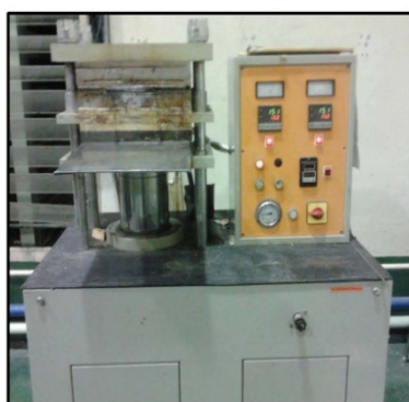
รูปที่ 2 กระบวนการอัดขึ้นรูปร้อนด้วยเครื่อง Compression molding machine
