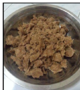
รูปที่ 1 เส้นใยจากกากกล้วยที่ผ่านกระบวนการสับและ ปั่นเรียบร้อยแล้ว
