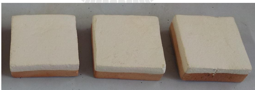
รูปที่ 3 ข ชิ้นงานเครื่องปั้นดินเผาต้านเคียวขึ้นที่ผ่านการเคลือบด้วยวิธีการจุ่มเคลือบ หลังผ่านการอบแห้งที่อุณหภูมิ 100°C ก่อนนำไปเผา Calcination
