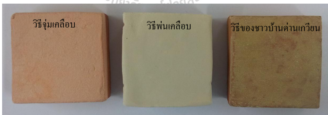
รูปที่ 7 เปรียบเทียบขั้วงานเครื่องปั้นดินเผาด่านเกวียนที่ผ่านการเคลือบด้วยวิธีการต่าง ๆ โดยใช้สูตรเคลือบเดียวกันคือสูตรที่ 2
