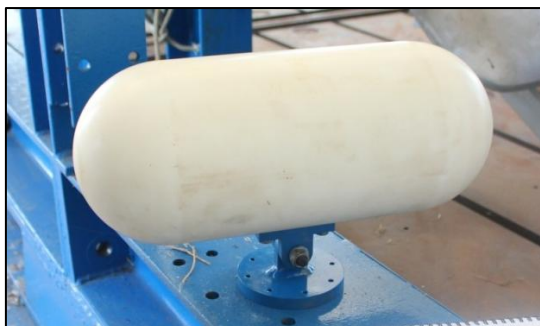
รูปที่ 2.2 อุปกรณ์ทดสอบความแข็งแรงของจุดยึดที่นั่ง
