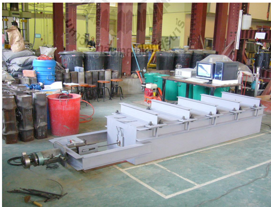
รูปที่ 3.3 อุปกรณ์ทดสอบแรงจุดของเหล็กเสริมแบกทาน
