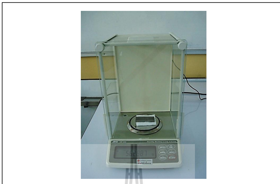
รูปที่ 3.10 เครื่องชั่งน้ำหนักที่มีความละเอียด 0.0001 กรัม
