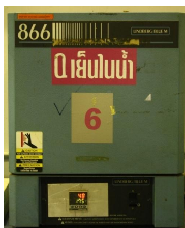
รูปที่ 3.4 แสดงภาพเตาเผาไฟฟ้า
