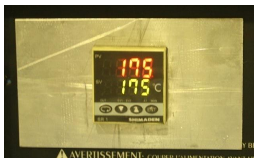
รูปที่ 3.10 แสดงการปรับตั้งอุณหภูมิเตาที่ 175^{\circ}\text{C}
