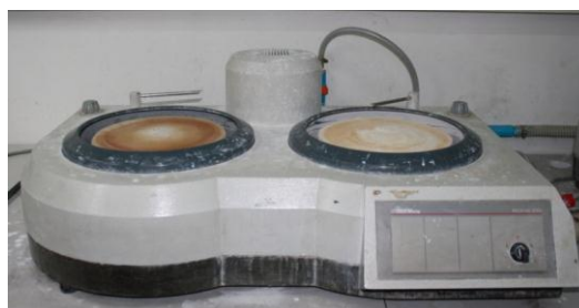
รูปที่ 3.17 แสดงภาพเครื่องขัดผ้าสักหลาด
