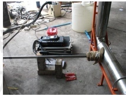
การตรวจวัดมลพิษอากาศจากไซโคลนสกรับเบอร์
