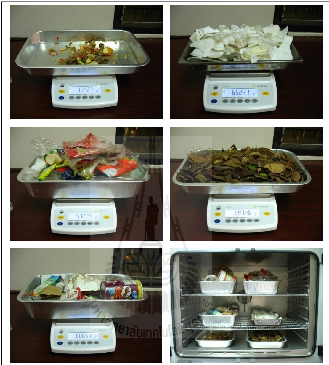
รูปที่ 4.2 การหาสัดส่วนและความชื้นของมูลฝอย
