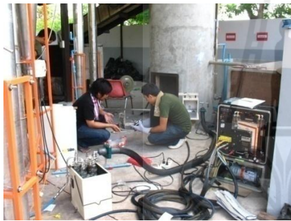
การตรวจวัดมลพิษอากาศจากไซโคลนสกรับเบอร์
