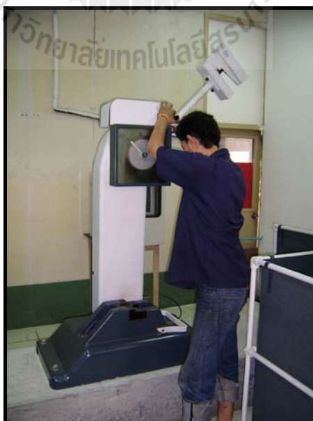
รูปที่ 3.15 เครื่องทดสอบค่าความต้านทานแรงกระแทก
