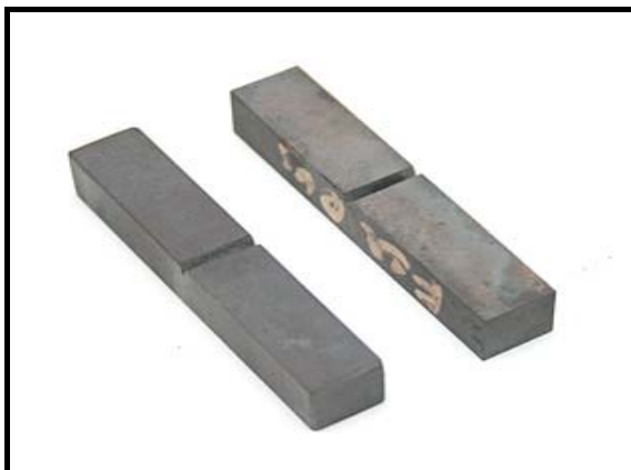
รูปที่ 3.21 รูปชิ้นงานทดสอบแรงกระแทกที่ได้ทำการขึ้นรูปตามมาตรฐาน
