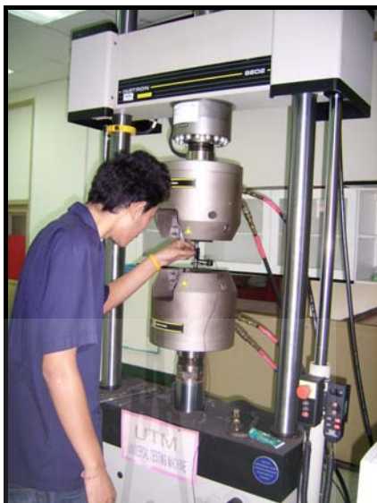
รูปที่ 3.14 เครื่องทดสอบแรงดึงของบริษัท Instron รุ่น 8802
