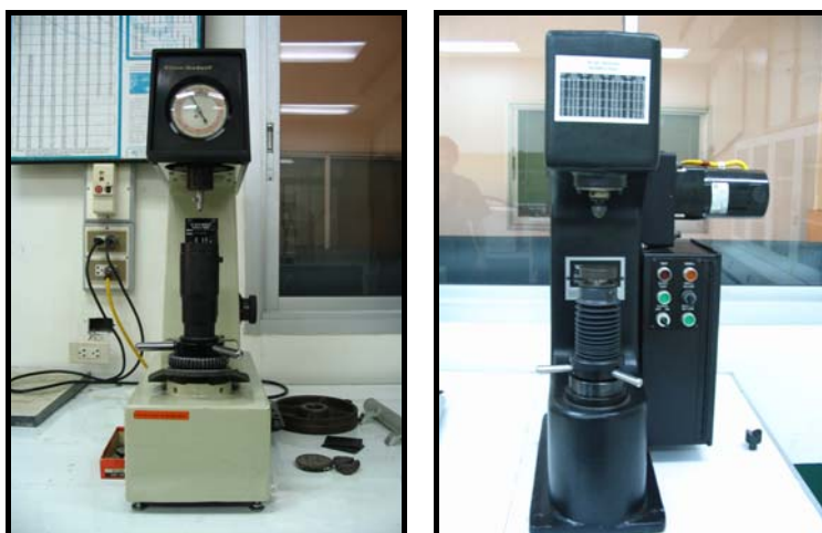
รูปที่ 3.13 เครื่องวัดความแข็งแบบร็อคเวล และแบบบริเนล
